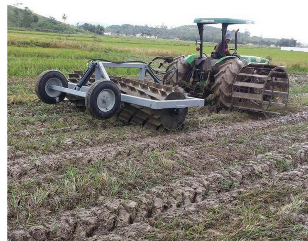
Operação com rolo-faca para incorporação de palha de arroz (Fonte: Metalúrgica Scarabelot)
